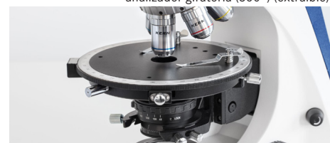
Platina para objetos de polarización centrable y giratoria
