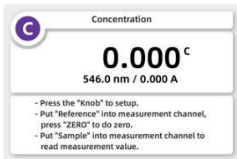
Fig. 6-5 La muestra patrón de calibración mide la concentración de la muestra desconocida
